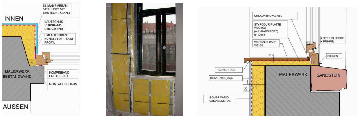
Bild 2. Der dichte Einbau der Fenster (Eigene Photos)
